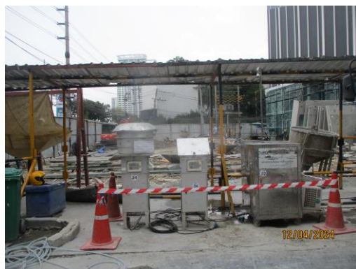
รูปที่ 11 การตรวจวัดฝุ่นละออง ภายในพื้นที่ก่อสร้างโครงการ
