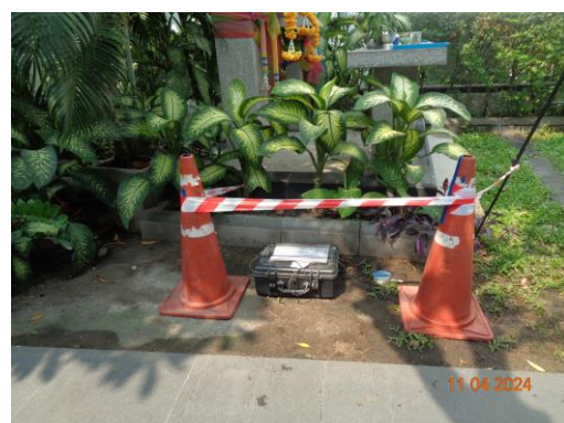
รูปที่ 17 การตรวจวัดความสั่นสะเทือนภายในพื้นที่เขต ติดต่อ (อาคารชุดพักอาศัย ไฟคัสเลน คอนโดมิเนียม)
