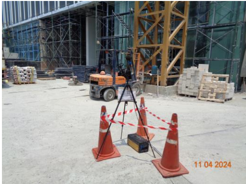
รูปที่ 13 การตรวจวัดระดับเสียง ภายในพื้นที่ก่อสร้างโครงการ
