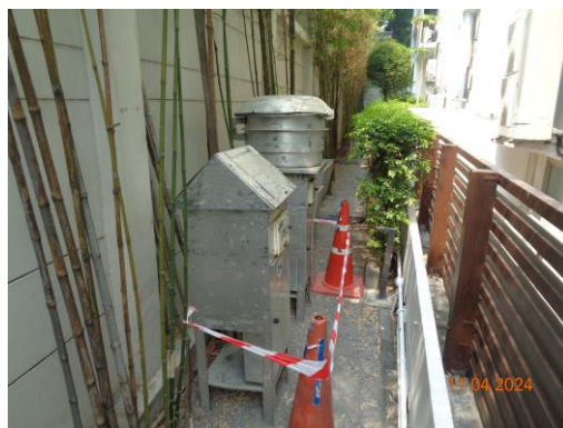
รูปที่ 12 การตรวจวัดฝุ่นละอองภายใน พื้นที่เขตติดต่อ (อาคารชุดพักอาศัย ไฟค์สเลน คอนโดมิเนียม)
